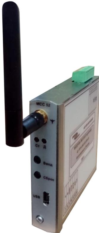
Предназначен для подключения любого управляющего контроллера к беспроводной сети.
